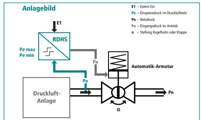
**Typ: RDHS Drucksicherungsautomatik „Sichere Versorgung“:**
