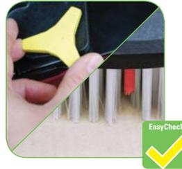
Wartungsbereiche für den Bediener in gelb. Bürsten mit Anzeige für maximalen Verschleiß.
