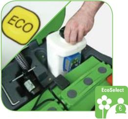
Reinigungsmittel-Dosiersystem separat von der Wasserabgabe. Führt zu erheblichen Einsparungen bei der Reinigungsschemie. Leicht entfernbarer Kanister.
