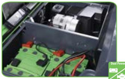
Innovatives Hybridsystem, mit dem die Maschine auf zwei Arten betrieben werden kann, mit Batterie und mit Verbrennungsmotor, wodurch sie in jedem Anwendungsbereich eingesetzt werden kann.
