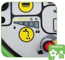
Möglichkeit zur Abgabe der Reinigungslösung in Abhängigkeit zur Maschinengeschwindigkeit.
