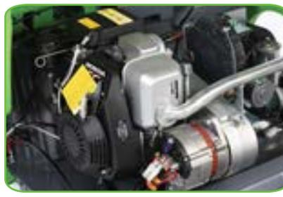
Erhaltlich mit Benzinmotor. Der Verbrennungsmotor ist an eine leistungsstarke 40 Ampere Lichtmaschine angeschlossen, die die verschiedenen Maschinenfunktionen einschaltet. Motorstart mit Seilzug.
