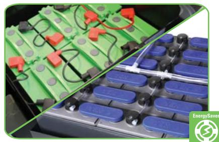
Wartungsfreie Batterien mit Gel-Technologie. Niedrige Selbstentladung und fast vollständig aus recycelbaren Materialien hergestellt. Auch Einzelzellenbatterie mit 18 Zellen à 2 V lieferbar.
