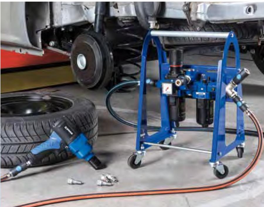
Rollwagen zur Druckluftversorgung und Druckluftaufbereitung
