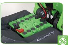
Wartungsfreie Batterien mit Gel-Technologie. Niedrige Selbstentladung und fast vollständig aus recycelbaren Materialien hergestellt.
