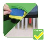
Wartungsbereiche für den Bediener in gelb. Bürsten mit Anzeige für maximalen Verschleiß.
