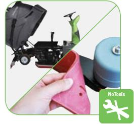
Leicht kippbarer Tank, zum besseren Zugang zu den Maschinenkomponenten.
