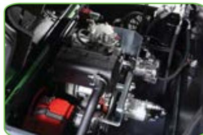
Erhältlich mit Dieselmotor, inklusiv Fahrsystem mit variablem Hydraulikantrieb.
