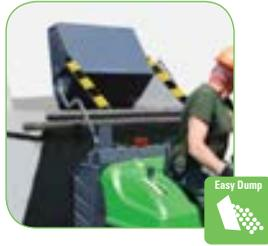
Großer Kehrgutbehälter mit hydraulischer Anhebung bis auf eine Höhe von 1430 mm zum Entleeren.
