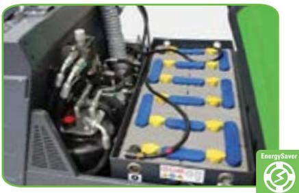
Extrem geräumiges Batteriefach. Erhältlich mit Batteriekasten inklusiv Nachfüllset.
