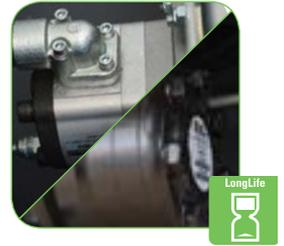
Hydraulikkreisläufe am Fahrtrieb und am Kehrsystem 2 Hydraulikpumpen für die Steuerung des Betriebs des Antriebsrads, der Walzen und der Öffnung des Kehrgutbehälters.
