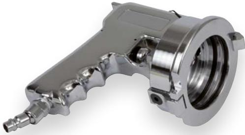
Kernstück des Systems ist die ergonomisch geformte Pistole aus hochfestem Aluminium. Die verchromte und robuste Ausführung garantiert eine lange Lebensdauer, auch in rauher Arbeitsumgebung. Der Leistungsbereich der Pistole umfasst Schläuche von DN 6 - DN 51 sowie Röhre mit einem Außendurchmesser von 6 mm bis 65 mm. Zum besseren Handling sind die Geräte mit einem drehbaren Druckluftanschluss versehen.
