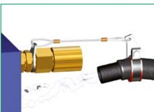
Das **STOPFLEX**-System ist für Verschraubungen nach DIN 2353, SAE-Flansche oder zur Befestigung an naheliegenden Maschinenteilen lieferbar.
