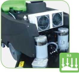
Bürstenbedienung über Stellantrieb von hoher Qualität, der konstanten Andruck auf dem Boden garantiert.
