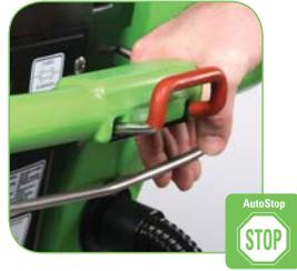
Einfaches Abschalten und Wiedereinschalten der Arbeitsfunktionen am Fahrgriff. Inklusive verzögertem Abschalten der Bürste und der Absaugung bei Arbeitsunterbrechungen.
